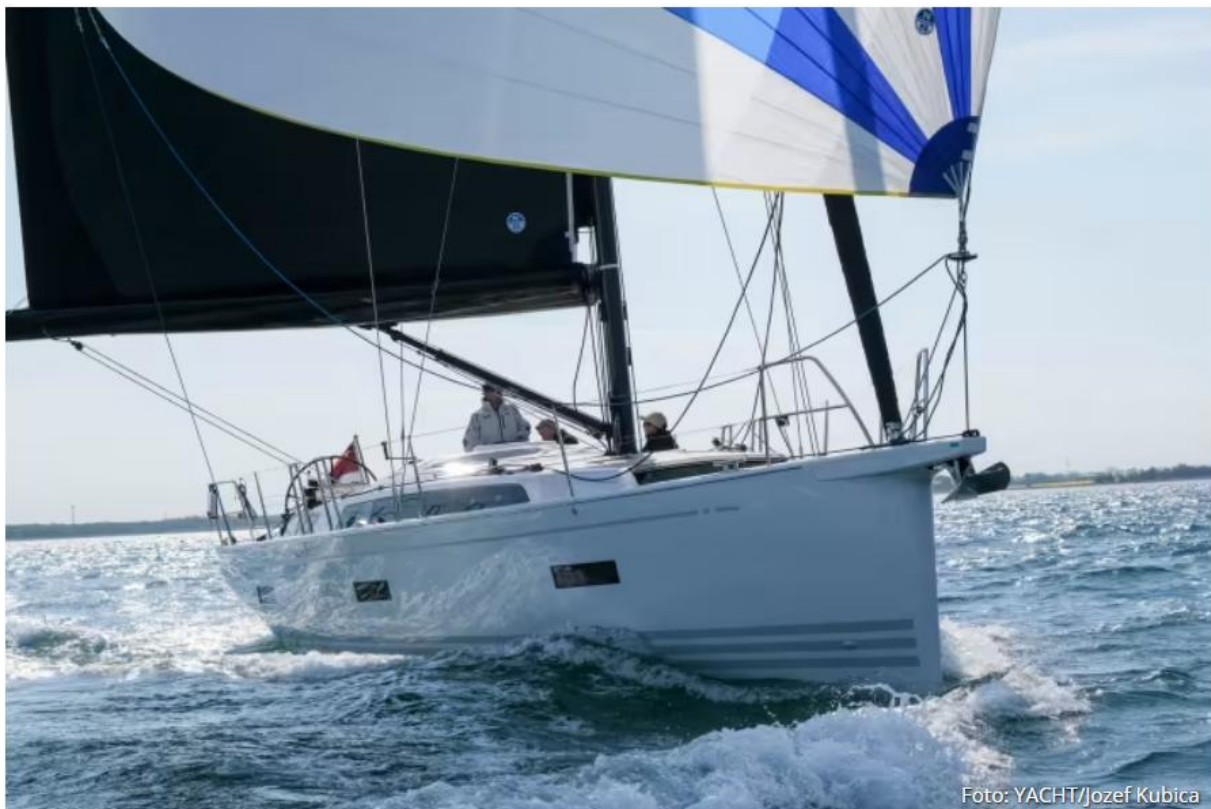
Foto: YACHT/Jozef Kubica Der Bugspriet ist jetzt länger und fest am Rumpf anlaminert
